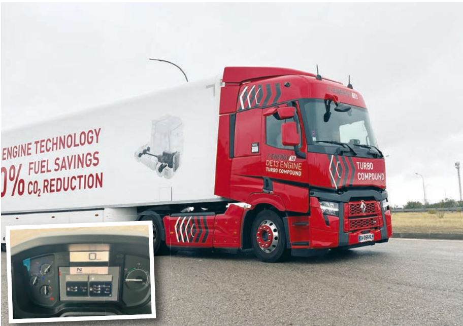
Este vehículo se caracteriza por un mayor aprovechamiento de la fase Optirroll , y su entrada en funcionamiento a menor velocidad, bajando hasta los 40 km/hora, lo que nos induce a pensar en una rango mayor de utilización, sobre todo en carreteras que no pertenecen a la red de alta capacidad.
