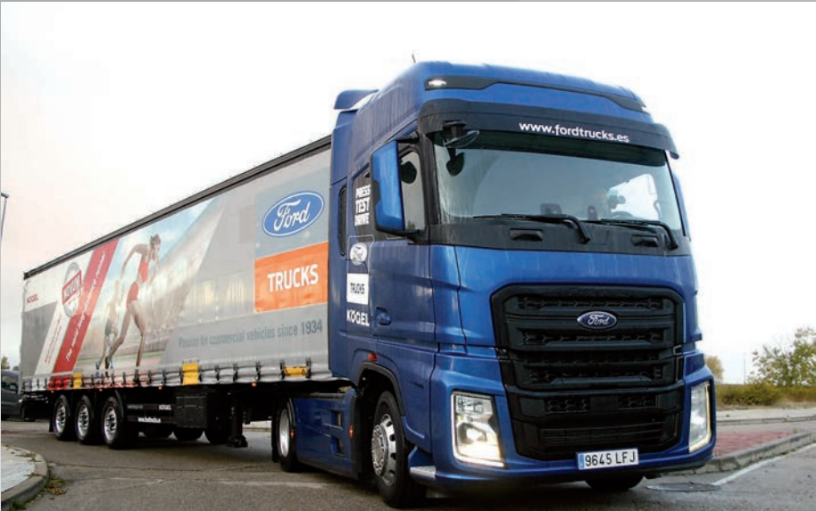
Para nuestra prueba el F-MAX arrastra un semirremolque tauliner Kögel de uso cotidiano, un conjunto mas cercano a un “camión de calle”, sin el uso de semirremolques aerodinámicos.
